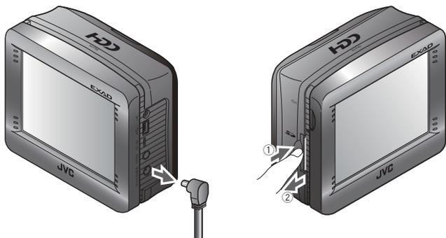
6. Placez l'interrupteur de la batterie sur « ON ».
